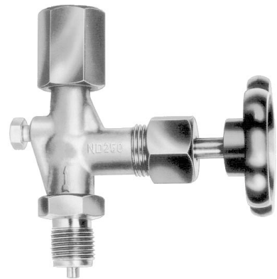
Standard valve per DIN 16 270, LH/RH adjusting nut/Male G ½, PN 250
